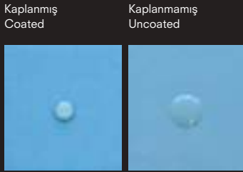
Yağ yüzeye damlıyor Oil dropped on the surface
